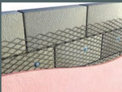
**Fixation :** Convient aux finitions en plâtre ou en enduit. Le produit SMHR SecuraMesh™ est fixé soit à l'aide d'une fixation adéquate agrafée ou bien d'une cheville et d'une vis M6 x 50mm et de rondelles galvanisées de 25mm dia. min. x 1,5mm fixées au maximum tous les 450mm.
