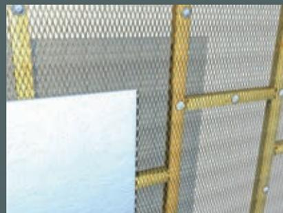
**Fixation :** Fixez au montant tous les 450mm au maximum à l'aide d'agrafes galvanisées de 30 à 38mm, de clous-vis galvanisés de 30 à 38mm ou bien de clous à plâtre clairs de 65mm x 3,35mm (norme BS1202) et de rondelles galvanisées de 25mm dia. min. x 1,5mm.
